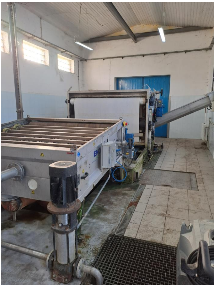
Rys. 8 Stacja odwadniania osadów
